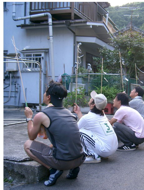
吹き流しを用いた同時多点での風向測定
